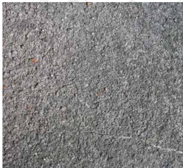
54 IL. Betonas su aiškiai matomomis smėlio dalelėmis
