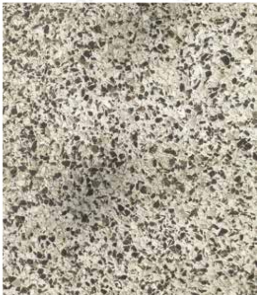
56 a IL. Šiurkštusis mozaikinis betonas
