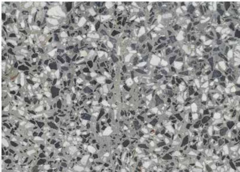
56 b IL. Poliruotas mozaikinis betonas
